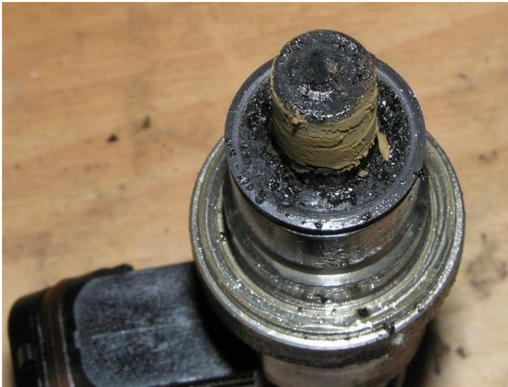
Крупный план забитого сопла.
