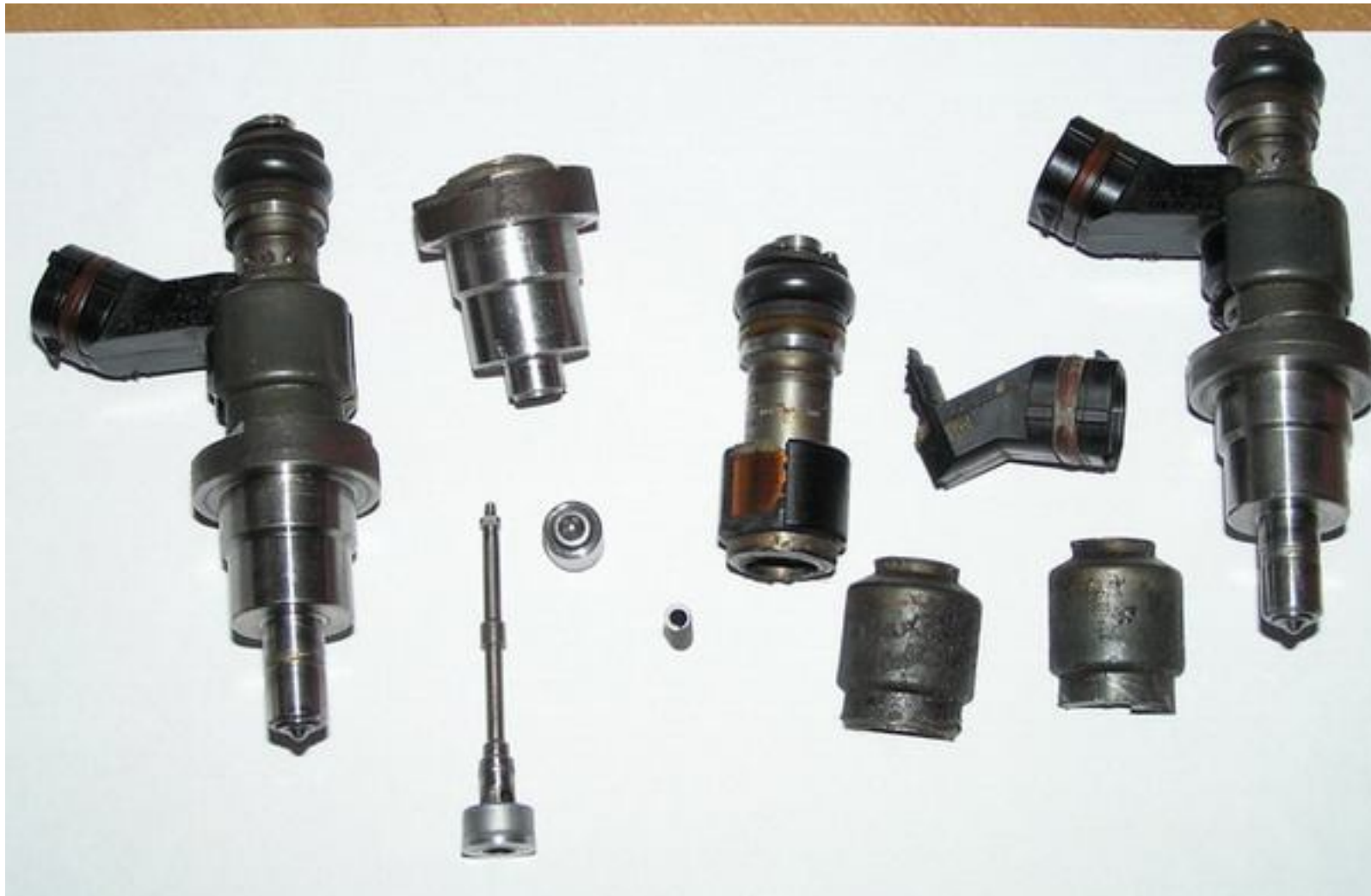
Распиленный инжектор от двигателя 1AZ-FSE.
