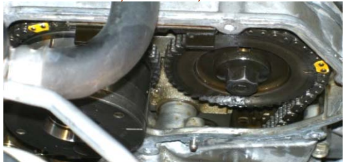
Метки ГРМ после перестановки обоих валов «вперед на один зуб» (слева видна муфта переменного газораспределения)
